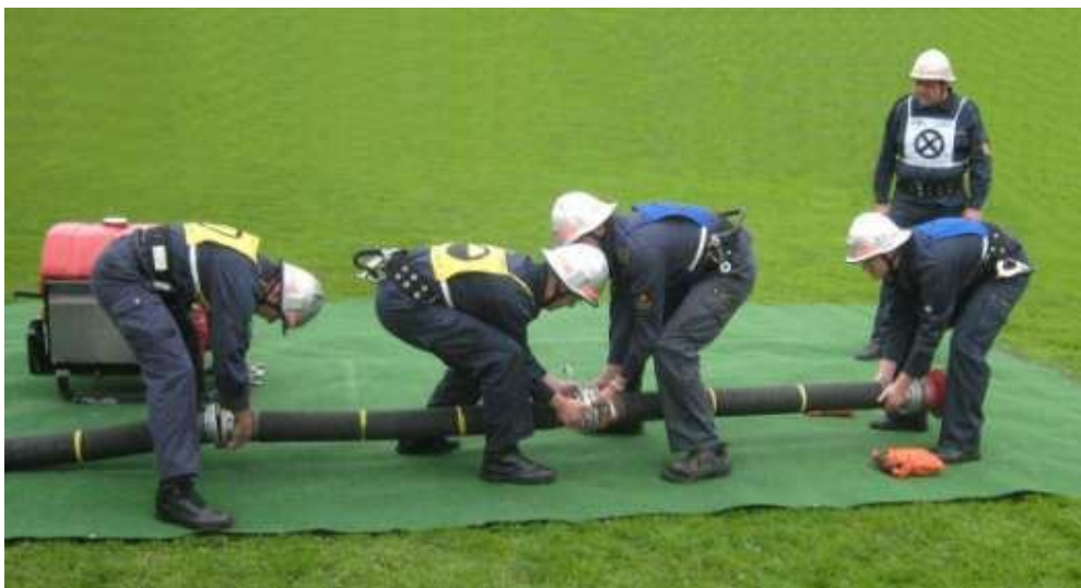
Rys. 7a: Łączenie linii ssawnej przez rotę drugą i trzecią.
