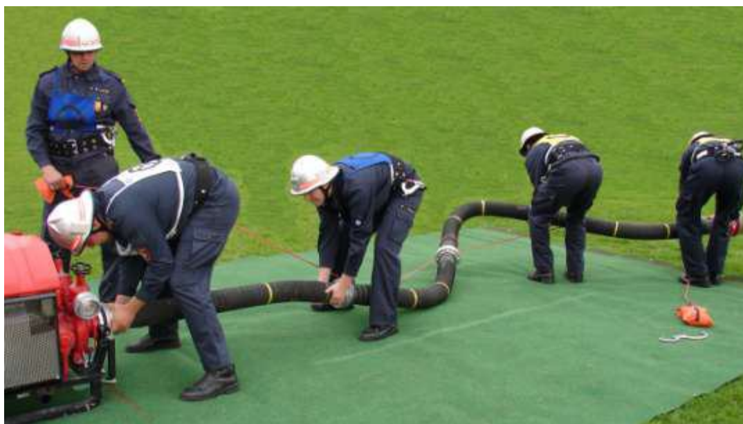
Rys. 14: Podłączanie linii ssawnej do motopompy.
