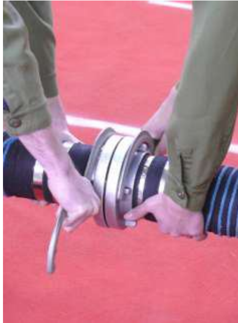
Rys. 8b: Nakładanie kluczy i łączenie węży ssawnych.
