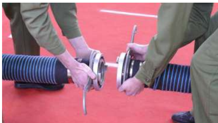
Rys. 8a: Nakładanie kluczy i łączenie węży ssawnych.
